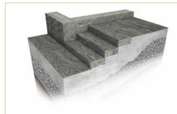
Escalier et marche palière posés sur plaque en béton armé
