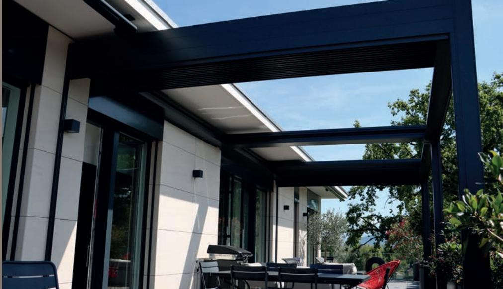
Pergola bioclimatique à lames orientables et rétractables. Les lames s'orientent et se rétractent d'un côté pour réduire considérablement l'obscurcissement de la maison en hiver.
